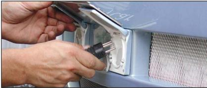
Das vordere Nummernschild verbirgt eine konventionelle 230 V Steckdose. Durch diese wird der HyCar zur mobilen Energie-quelle für Handwerker oder bei Freizeitaktivitäten.
