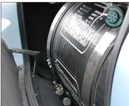
Der HyCar wird mit gasförmigem Wasserstoff betrieben. Dieser wird in zwei Hochdrucktanks bei 200 bar gespeichert. Jeder Tank verfügt über einen gasdichten Innentank aus Aluminium, der mit Kohlefasern umwickelt ist und wiegt 32 kg. Damit können pro Tank 76 Liter Wasserstoff gespeichert werden. Die Betankung erfolgt z.B. über die HyStation und ist so sicher und bequem wie bei einem konventionellen Fahrzeug.
